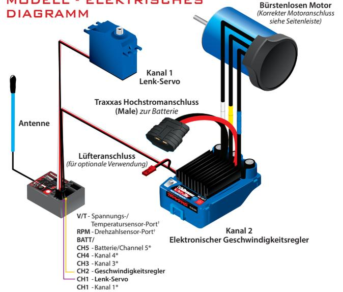
\* Nicht verwendet † Zusätzlicher Sensoranschluss zur Verwendung mit der Standard-Sensoren (Spannungs-/Temperatursensoren und Drehzahlsensoren (mehr Informationen auf Traxxas.com und in den mitgelieferten Materialien))
