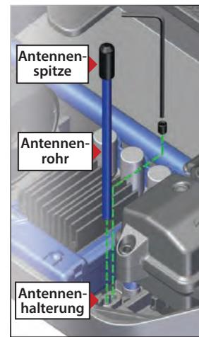
**!** Um einen Verlust des Funksignals oder eine Reduzierung der Reichweite zu vermeiden, bitte das schwarze Kabel nicht scheiden oder knicken, die Metallspitze nicht biegen oder abschneiden und das weiße Kabel am Ende der Metallspitze nicht biegen oder abschneiden.
